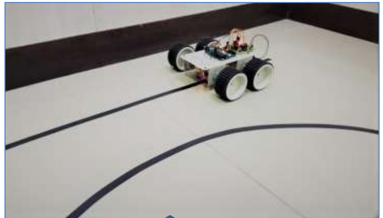
Robot suiveur de ligne noire avec compteur
