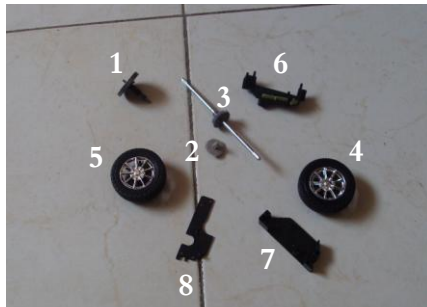
تفكيك نظام توصيل الحركة وتخزينها
