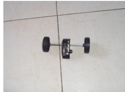
العجلات الخلفية للسيارة اللعبة مزودة بنظام توصيل الحركة وتخزينها
